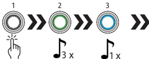
Stavite master-prst na senzor na cca tri sekunde, maknite prst
