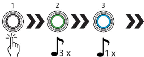
Stavite prst na senzor na cca tri sekunde, maknite prst
